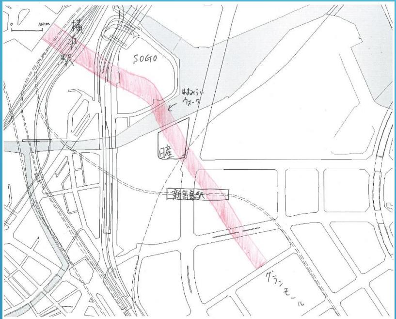
赤い部分に図1で示したデッキレベルの通路を通す。改札を置いた横浜駅2階からそごうを通り抜け、みなとみらい中央のグランモールへ接続する。
